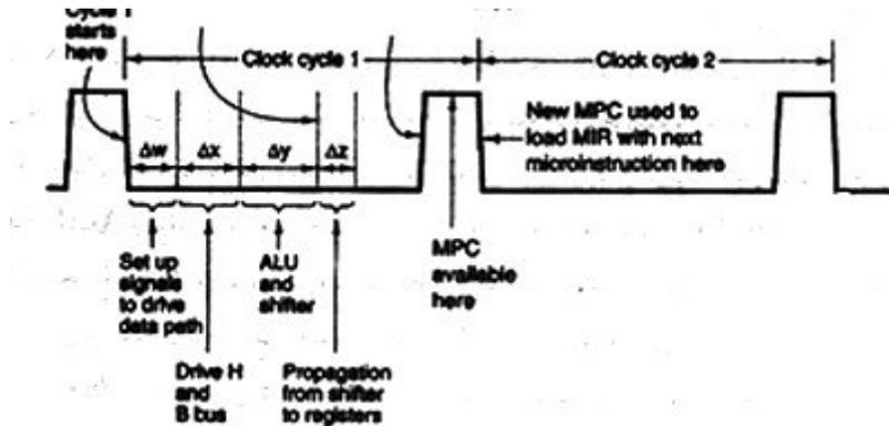
۱.  $\Delta X + \Delta Y + \Delta Z$  بعد از لبه پایین رونده و قبل از لبه بالا رونده.
